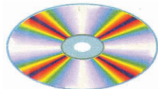
სურ. 45.2. კომპაქტ-დისკი თავისი დაკვალული ზედაპირით ამრეკლი დიფრაქციული მესერია.
